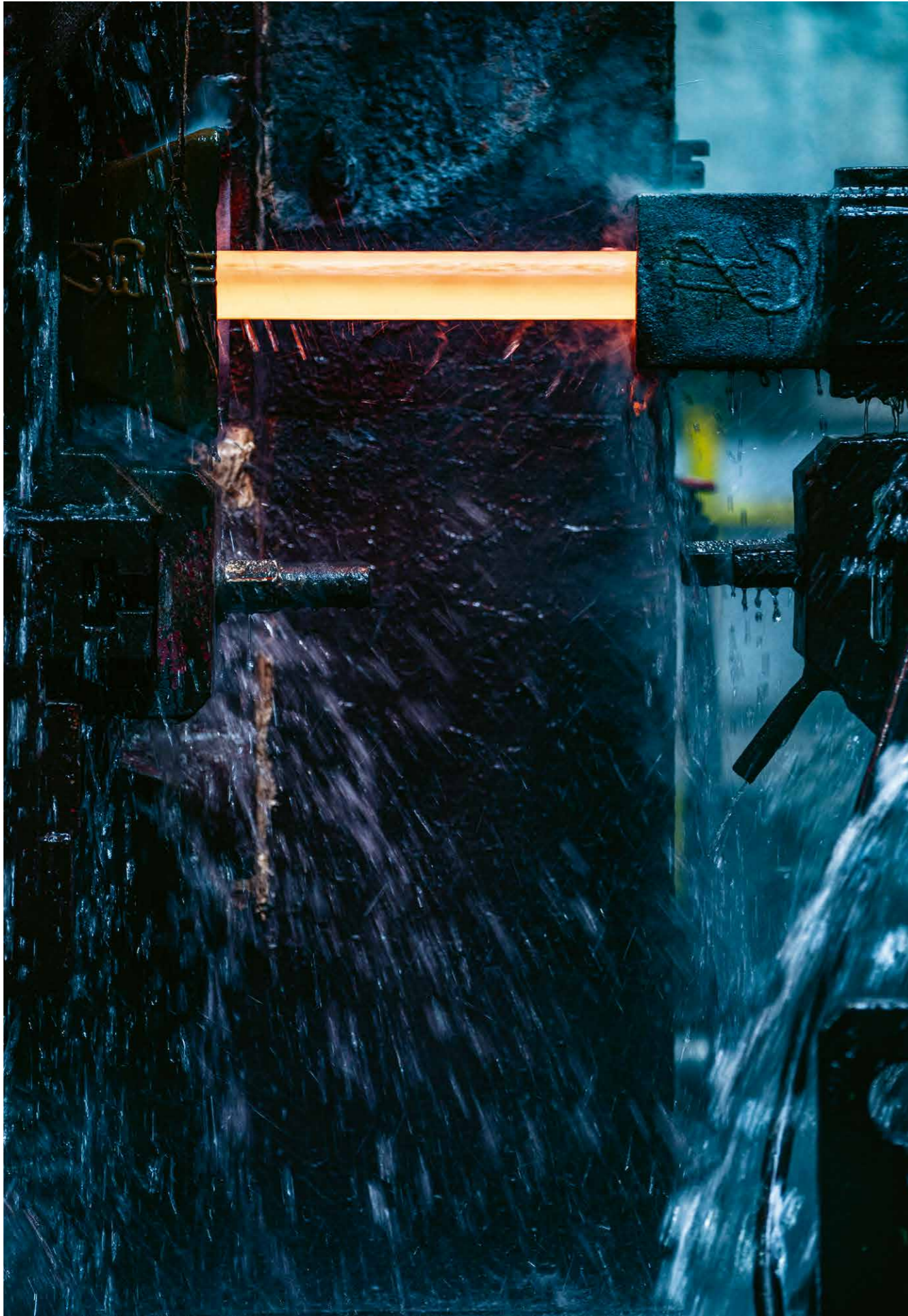
Zum Walzen braucht es Kühlwasser. In der Marienhütte wird das gesamte Kühlwasser im Kreis geführt, das bedeutet: Das Wasser wird gereinigt und wieder zur Kühlung verwendet.
