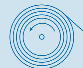
8 Spulanlage Auf der Spulanlage wird das schon auf Enddurchmesser gewalzte Walzgut bei 600 °C mit bis zu 30 m/s zu Betonstahlringen aufgespult.
